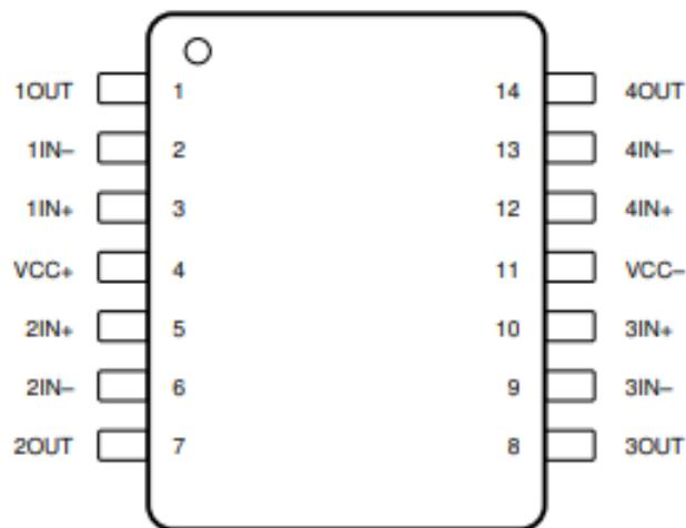
Figure 3.87: TL084 Pin Diagram
