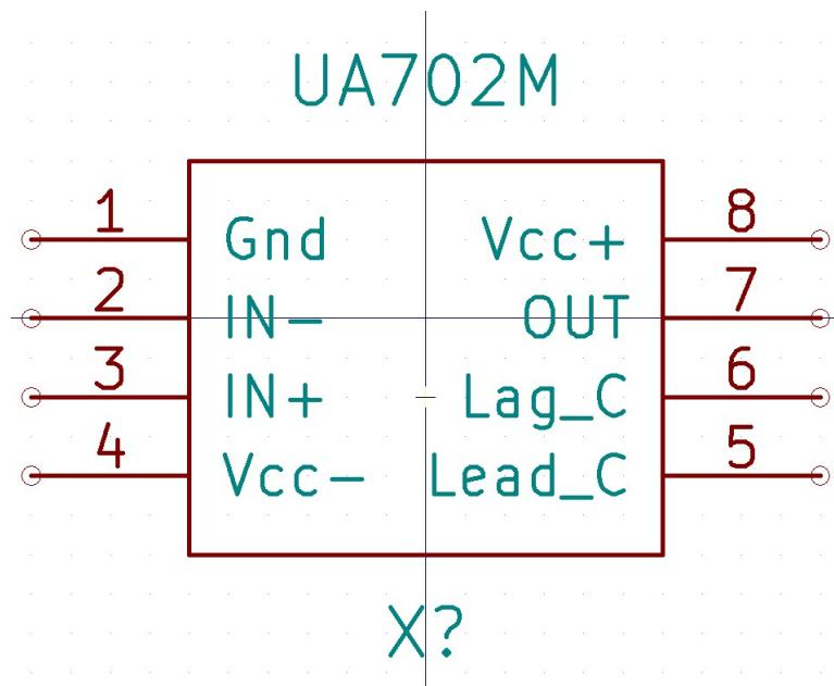
Figure 3.153: UA702 Pin Diagram
